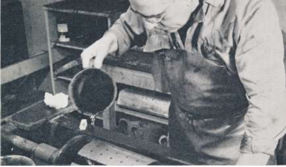
Etser bewerkt de cilinders met ijzerchloride.
